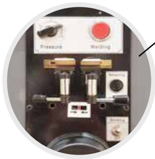
Knip-, las- en slijpinrichting t.b.v. lintzaagblad
